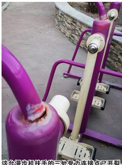
这台漫步机扶手的三处受力连接点已开裂。
